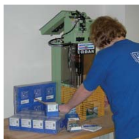
Aplikační test: ukázka zavrtání šroubu do okenního profilu automatickou šroubovací jednotkou značky Urban
