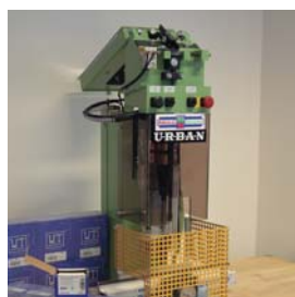
Aplikační test: ukázka zavrtání šroubu do okenního profilu automatickou šroubovací jednotkou značky Urban
