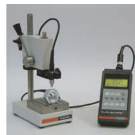
Měření tloušťky povrchové vrstvy: sonda společně s vyhodnocovací jednotkou měří tloušťku povrchové vrstvy
