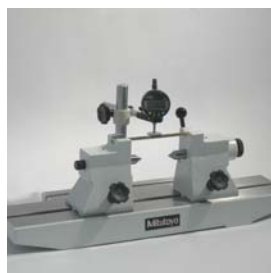
Kontrola obvodového házení: měření přímosti šroubů
