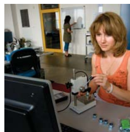
Měření tloušťky povrchové vrstvy: sonda společně s vyhodnocovací jednotkou měří tloušťku povrchové vrstvy
