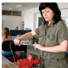
Měření pevnosti v krutu: ráčna a digitální vyhodnocovací jednotka slouží k měření kroutícího momentu, samozřejmostí je zaznamenání maximální hodnoty
