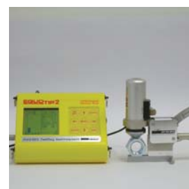
Zkouška tvrdosti: variabilní přenosný tvrdoměr se používá k měření tvrdosti materiálu
