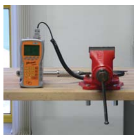
Měření pevnosti v krutu: ráčna a digitální vyhodnocovací jednotka slouží k měření kroutícího momentu, samozřejmostí je zaznamenání maximální hodnoty
